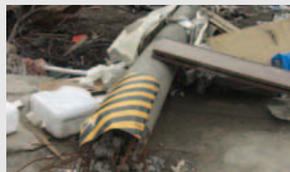
根元から折れた電柱
